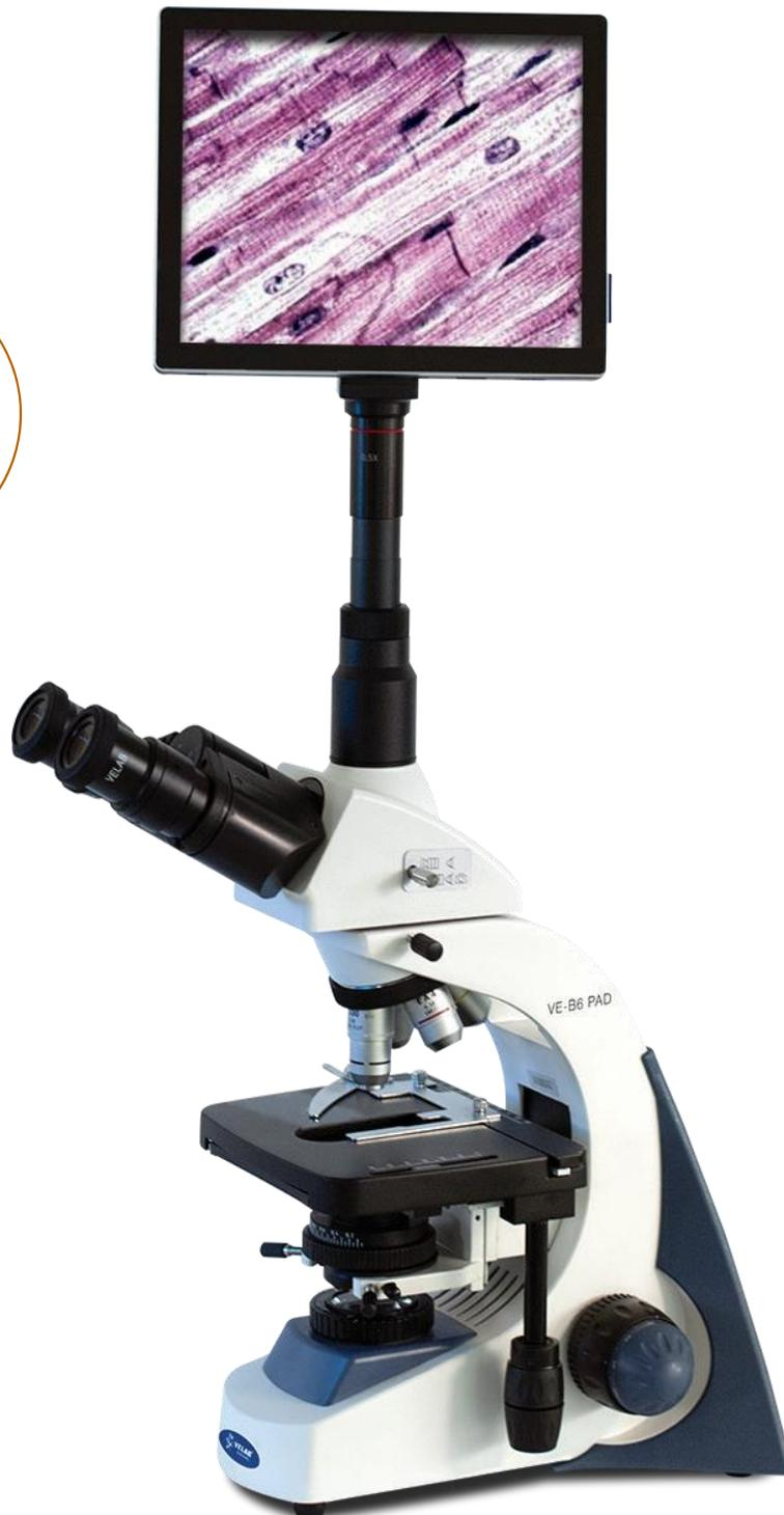
Microscopio de uso profesional ideal para investigación, educación superior y trabajo de rutina en laboratorios clínicos. Equipado con el dispositivo SCOPEPAD que consta de una cámara digital de 5.0 MP adaptada a una tablet de 9.7", completamente desmontable con sistema operativo Android.
