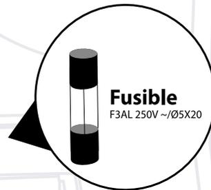
3. Desatornille el porta fusible y coloque el “F3AL250V” en el soporte, atornille de vuelta.
