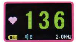
A. Indicador de Batería/Cargador B. Indicador de Volumen C. Frecuencia de trabajo de la sonda del ultrasonido. D. Área de Visualización FCF
